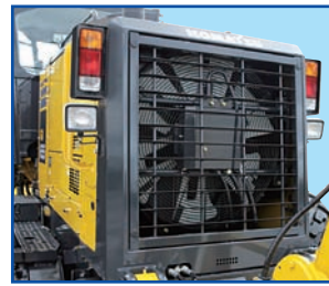
Inversão de sentido do ventilador de arrefecimento
