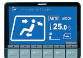
A função de controle em dois níveis mantém a cabeça do operador refrigerada e seus pés aquecidos. Essa avançada função de controle do fluxo de ar mantém o interior da cabina agradavelmente climatizado ao longo das quatro estações do ano. A função do desembaçador conserva o vidro da cabina desembaçado. O conforto para o operador é total.
