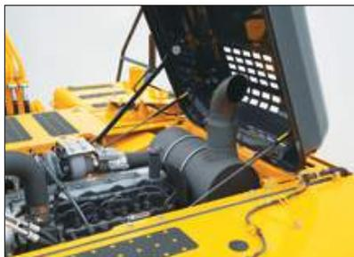
**Protetores térmicos e da hélice do ventilador**
