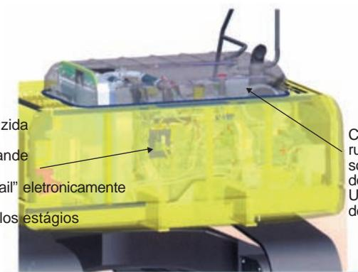
Cobertura de isolamento de ruídos em torno do silencioso e da tubulação de escape dos gases
