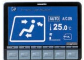
A função de controle em dois níveis mantém a cabeça do operador refrigerada e seus pés aquecidos. Essa avançada função de controle do fluxo de ar mantém o interior da cabina agradavelmente climatizado ao longo de quatro estações do ano. A função do desembaçador conserva o vidro da cabina desembaçado. Conforto total ao operador.
